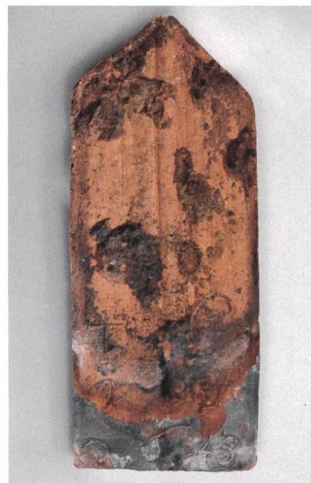
Abb. 4 Biberschwanzziegel aus der Stadtziegelei Kloter. Breite 15 cm. Inschrift «T[homas] k[loter], b[ürger] Zug» und Jahreszahl «1643».
