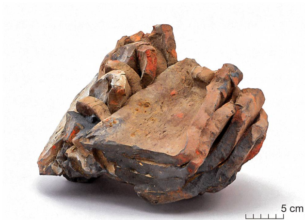
Abb. 46 Schützenmatt. Massiver Block aus zusammengeschmolzenen, überfeuerten neuzeitlichen Dachziegeln, offenbar entstanden in Folge eines zu heiss gefahrenen Ziegelofens.
