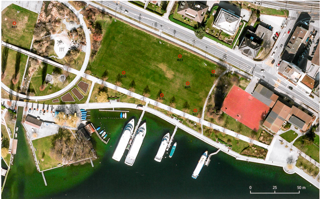
Abb. 44 Zug, Schützenmatt. Lage der Bohrungen B01–B06 auf der Schützenmatt und B07 im Europaring, auskartiert auf dem kantonalen Orthofoto 2011, genordet. Östlich der Wiese die Turnhalle Schützenmatt mit ihrem Aussensportplatz im Bereich des ehemaligen Aabachs, links im Bild der durch den Europaring fließende Siehbach. Der Verlauf der Uferverbauung deutet eine leichte Buchtsituation an.
