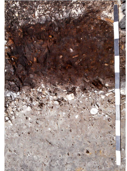
Abb. 28 und 29 Steinhausen, Hiltibrunnen, Zentrum «Dreiklang» . Links: Bauplatz vor Beginn des Aushubs der Baugrube. Rechts: Ausschnitt aus der Baugrubenwand zur Bahnhofstrasse hin, mit gut erhaltener Torfschicht über Bach- und Seeablagerungen.
