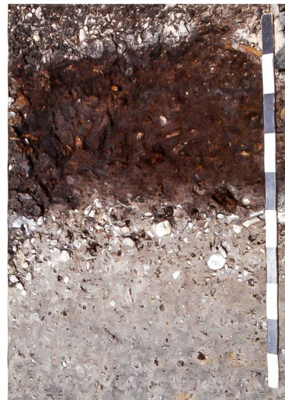
Abb. 28 und 29 Steinhausen, Hiltibrunnen, Zentrum «Dreiklang» . Links: Bauplatz vor Beginn des Aushubs der Baugrube. Rechts: Ausschnitt aus der Baugrubenwand zur Bahnhofstrasse hin, mit gut erhaltener Torfschicht über Bach- und Seeablagerungen.
