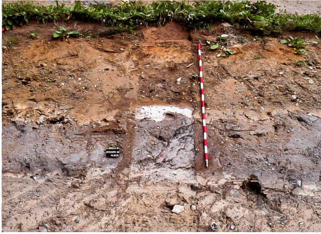
Abb. 13 Cham, Eichmatt II. Stichprofil in der Baugrubenböschung im Nordosten des Bauperimeters, Blick nach Nordnordost. An der Profilbasis ist die Grundmoräne aufgeschlossen, darüber liegt nach einer Übergangszone dunkelgrauer, heterogen kiesig-sandiger glazialer Beckenton, auf dem weisse, leicht sandige Seekreide aufgelagert ist. Den Profilabschluss gegen oben bilden Deltasedimente und kolluviale Hanglehme.
