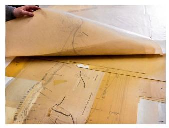
Abb 7 Brüchige, saure Transparentpläne aus dem frühen 20. Jahrhundert bedürfen einer sorgfältigen Restaurierung. Eine Benutzung in diesem Zustand ist kaum mehr möglich, da bei jeder Bewegung Stücke aus dem Papier brechen können.
