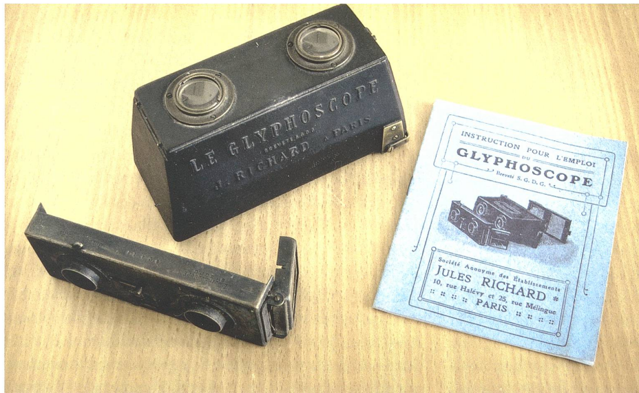
Abb. 11 Stereoskopischer Betrachtungs- apparat «Glyphoscope», zum Betrachten von Glasplatten- Fotografien mit räumlicher Wirkung, Firma Jules Richard, Paris, um 1910.
