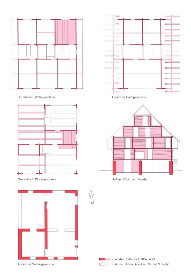
Abb. 38 **Oberägeri, Gulmstrasse 62, Gasthaus Gulm.** Grundrisse und Aufriss. Massstab 1:200.
