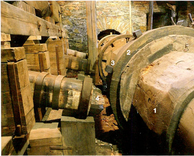
Abb. 3 Antrieb des mechanischen Schmiedehammers. 1 Die mächtige Welle, meist ein Eichenstamm, wird vom Wasserrad gedreht. 2 Der Nockenkranz mit den in gleichmässigen Abständen angebrachten Metallnocken dreht sich mit der Welle. 3 Der einzelne Nocken erfasst den Hammerstiel. 4 Der Hammerstiel wird niedergedrückt und hebt dadurch den Hammerkopf hoch. Beim Weiterdrehen der Welle gibt der Nocken den Stiel wieder frei, und der Hammerkopf fällt durch sein Eigengewicht mit grosser Wucht auf das Werkstück. Althammer der Saigerhütte Grünthal im sächsischen Erzgebirge.
