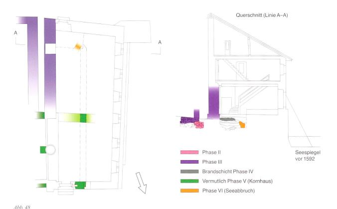
**Zug, Unteraltstadt 14a, Fischereimuseum.** Grundriss des Erdgeschosses mit den mutmasslichen Spuren des Kornhauses von 1427/28 (links) und Querschnitt (Linie A–A) mit Blick nach Süden (das Grabungsprofil ist seitenverkehrt gezeichnet, vgl. Abb. 47). Der Bestand ab Phase VII ist nicht gefärbt. Massstab 1: 200.
