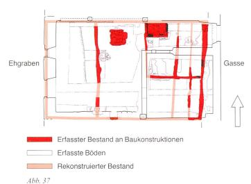
**Zug, Oberaltstadt 13, Wohnhaus.** Grundriss des Schwellenbaus, der vermutlich nach 1334 erbaut wurde und 1370/71 abbrannte. Im Mittelteil befinden sich die Küche, an der Gasse im Osten die Stube und der Eingang. Massstab 1:150.
