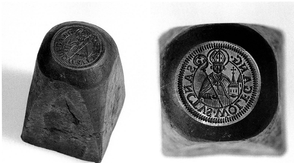
Abb. 9 Münzstempel zur Prägung der Rückseite des Zuger Schillings von 1784 (Kantonsarchäologie Zug, Ereignisnr. 508, Fundnr. 239.1020), Höhe 57,7 mm, Durchmesser der Prägefläche 22,4 mm. Gesamtansicht (links) und Prägefläche (rechts).
