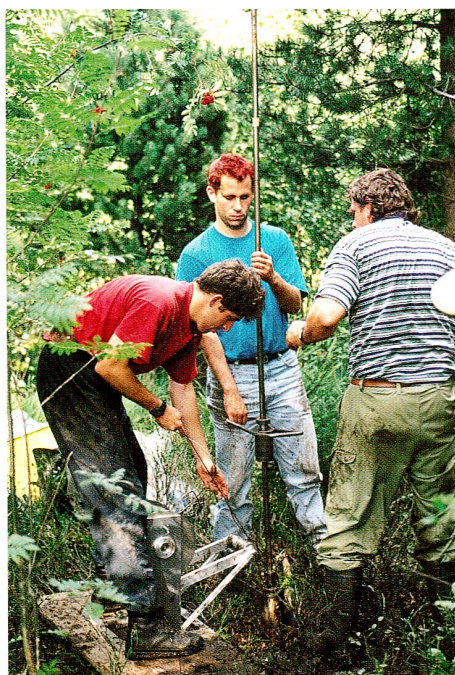
Abb. 4 Bohrung im Hochmoor Egelsee. Hochziehen eines Stückes des Bohrkerns EGL2. Am unteren Ende des Bohrgestänges kommt das Stechrohr zum Vorschein.
