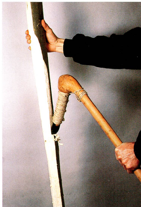
Zurichten des Holmrohlinges mit dem Dechsel.
