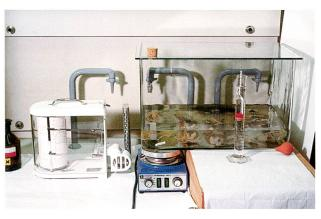
Abb. 21 Cham-Eslen. Restaurierung der Doppelaxt. Messungen des Austauschs des Wassers durch Alkohol im Restaurierungslabor des Museums für Urgeschichte in Zug.
