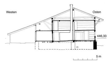
Abb. 21 Hünenberg, Burgstrasse 18. Schematisierte Umzeichnung der Grundrisse des Unter-, Erd- und Obergeschosses sowie West-Ost-Schnitt. Die ältesten Teile des Hauses stammen aus dem ausgehenden 16. Jahrhundert. Sie sind schwarz eingefärbt.
