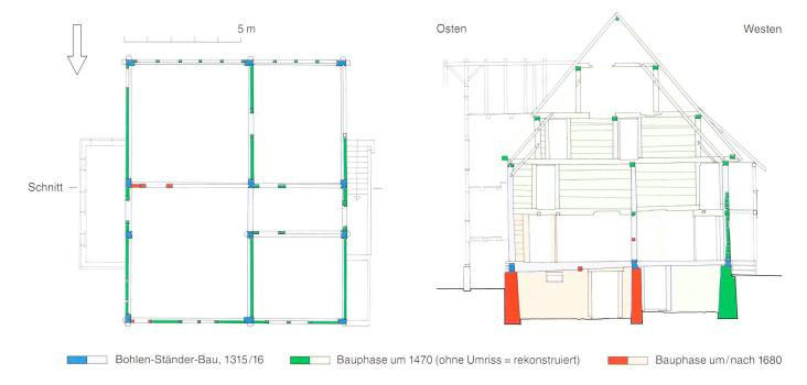
Abb. 12 Steinhausen, Bannstrasse 4. Grundriss des Erdgeschosses, mit Angabe der Bauphasen.
