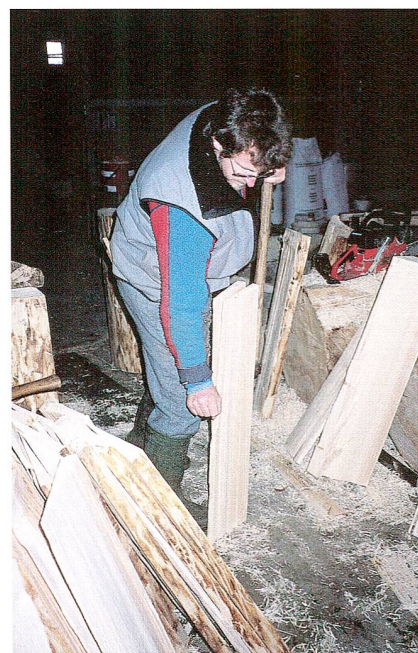
Abb. 8 Heiri Föhn aus Illgau beim Herstellen von grossen Weissstannenschindeln. Er benutzt dazu ein spezielles Werkzeug, das Schindeleisen.
