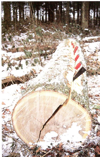
Abb. 6 Eine ganze Serie von Keilen war notwendig, um die mächtige Eiche gerade zu spalten. Aus den Spältlingen – der Baum wurde geviertelt – wurden die tragenden Pfosten herausgearbeitet.
