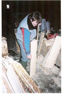
Abb. 8 Heiri Föhn aus Illgau beim Herstellen von grossen Weisstannenschindeln. Er benutzt dazu ein spezielles Werkzeug, das Schindeleisen.
