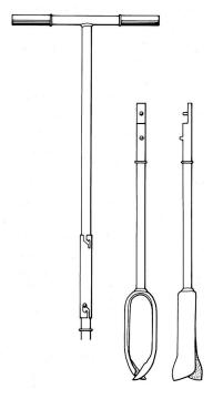
Abb. 15 Baar, Baarburg. Handbohrer mit offenem Bohrkopf. M 1:10.
