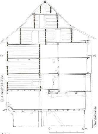
Abb. 6 Zug, St.-Oswalds-Gasse 16/18. Ost-West-Querschnitt, Blick Richtung Süden, im Bereich des Hauses Nr. 16.
