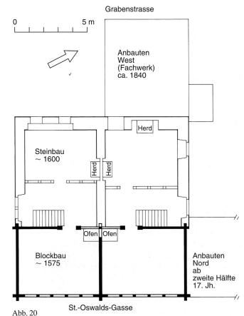
Zug, St.-Oswalds-Gasse 16/18. Schematisierter Grundriss des 1. Obergeschosses mit Angabe der Bauphasen.
