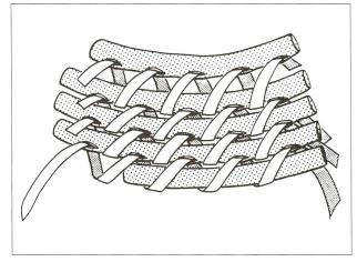
Abb. 7 Schema eines Wulsthalbgeflechtes.
