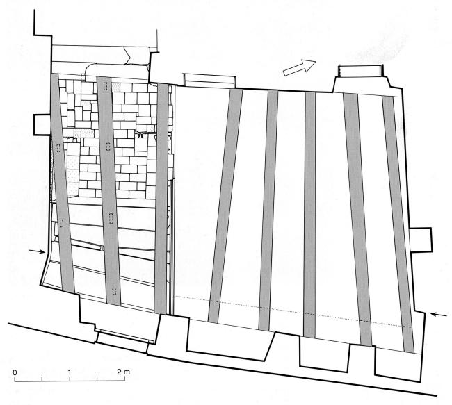
Abb. 30 Zug, Grabenstrasse 44. Grundriss Erdgeschoss, östlicher Hausteil, Schnitthöhe knapp oberhalb des aktuellem Fussbodens. Angegeben ist der Tonplattenboden im Südteil, die beiden Pfeile weisen auf Wandvorsprünge bzw. Mauerfugen. Gerastert angegeben sind die Unterzüge der Decke; die Punktlinie gibt die durch entsprechende Abdrücke an diesen Balken zu vermutende Mauerflucht an.
