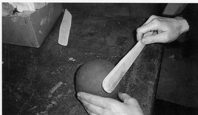
c: Mit einem Holz wird der Gefäßunterteil in die Form geschlagen.
