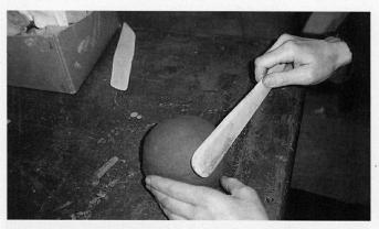
c: Mit einem Holz wird der Gefässunterteil in die Form geschlagen.
