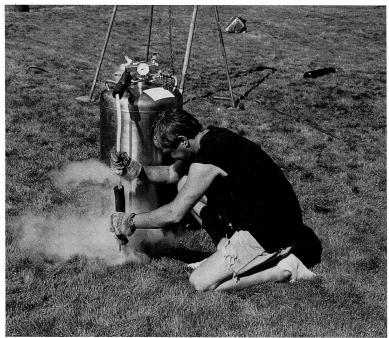
Proben aus dem Boden zu ziehen, erlaubt, Schichtabfolgen ohne Verfälschung studieren zu können. Diese Art von Bohrsondierung wurde unseres Wissens erstmals vom Büro für Archäologie der Stadt Zürich eingesetzt.<sup>3</sup> Wir haben diese Methode übernommen und weiterentwickelt.<sup>4</sup>
