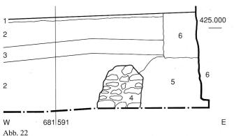
Zug, Grabenstrasse18 und 20. Nordprofil (zur Lage vergleiche Abbildung 21). M. 1:50. 1 Asphalt, 2 Einfüllung, stark von Wurzelwerk durchsetzt, 3 Telephonleitungen, 4 Mauer aus Bruchsteinen und Kalkmörtel, 5 Anstehender Boden aus sandig-kieseligem Material, 6 Substruktion des Toilettengebäudes.
