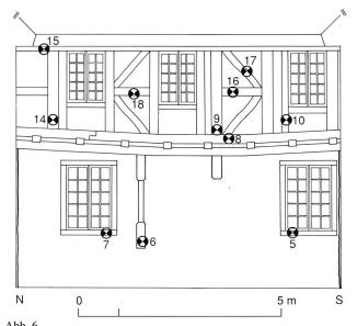
Abb. 6 Zug, Kloster Maria Opferung: Umzeichnung der östlichen Innenwand auf der Grundlage der Aufnahmepläne der Firma Karl Matter, Baar; eingetragen sind die konstatierten Befunde, zu den angegebenen Nummern der dendrochronologischen Proben vergleiche Anmerkung 12. M. 1:100.
