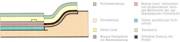
Abb. 106 Schnitt durch die Farbschichten an der Aussenseite des profilierten Türflügels.
