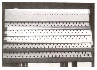
Abb. 101 Windverführungen im Pfeifenstock.
