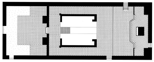
um 10 cm tiefer liegt, setzten sich die Tonplatten vom Format 22 x 22 cm fort. Sie sind verschränkt verlegt. Dabei verlaufen die Hauptfugen vor dem Lettnerdurchgang und den beiden Altären quer, entlang den Längswänden aber parallel zur Kirchenachse. Im westlichen Bereich des Laienschiffes bleibt der originale Mörtelfussboden erhalten (Abb. 88). Im Kreuzgang bilden die Tonplatten dieser Bauphase den noch heute benützten Boden.
