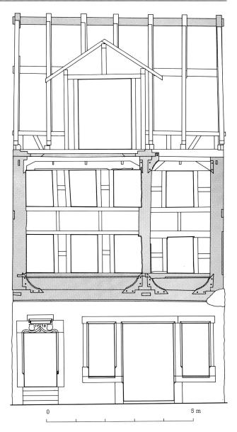
Abb. 18 Zug, Haus Untergrasse 19, Westfassade. Grau getönt die Konstruktionsteile des ersten Bohlenständerbaus, vor 1500.
