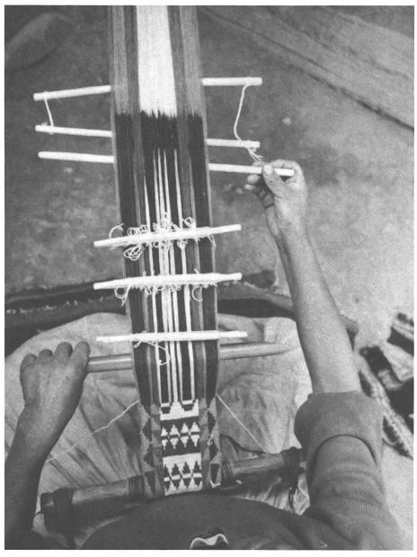
Von grosser Wichtigkeit zum Einlesen der Muster ist dieser Stab, *Shujshu* genannt; immer das zuletzt gewobene Fach wird damit fixiert und dient als neue Ausgangslage für das Einlesen des nächsten Musterfaches.
