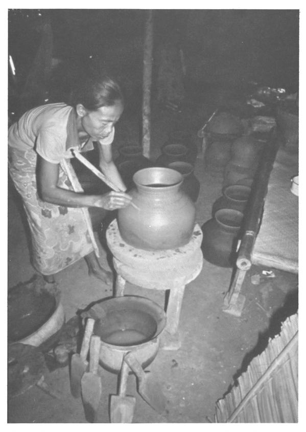
Abb. 5 Ornamentieren des Gefässes durch Abnehmen dünner Streifen des Überzugs
