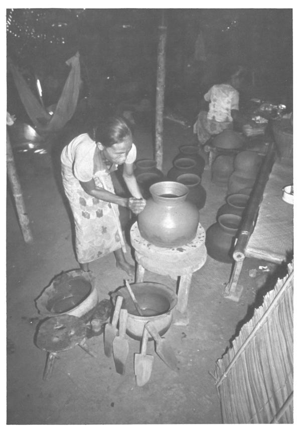
Abb. 3 Ein hellroter Tonüberzug wird angebracht
