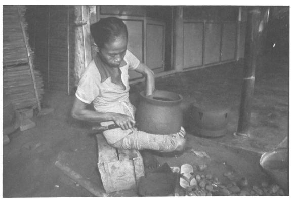
Abb. 4 Ibu Nurpangi schneidet die Luftlöcher in den fertigmodellierten Keramikofen
