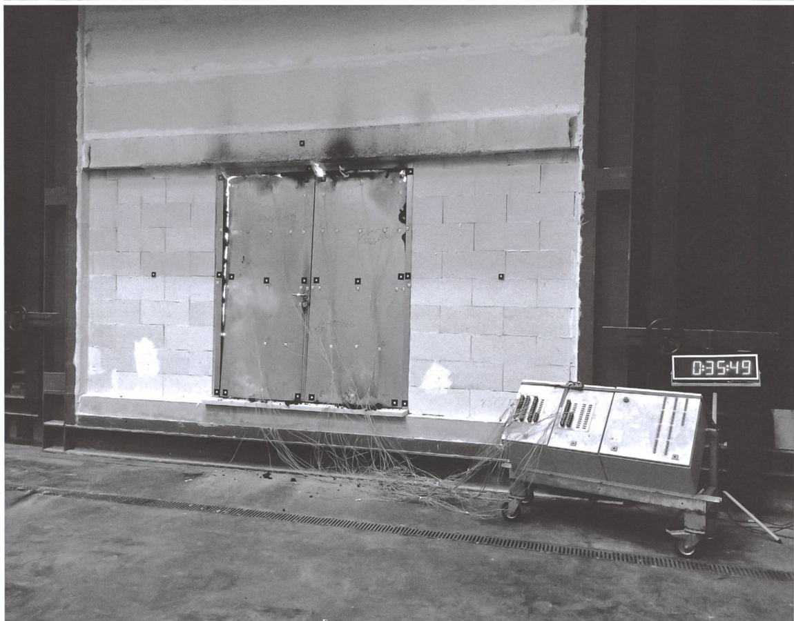
(Abb. a, b) Brandprüfung der Messingtüren für die Erweiterung des Kunsthauses Zürich. Bild: Hersteller Brandschutztüren, Jegen AG
