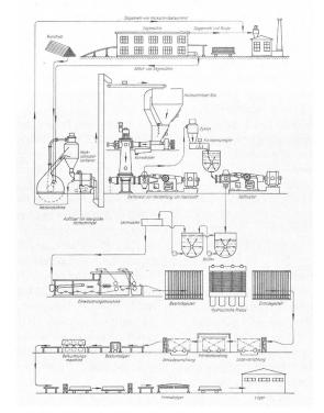
Schema zur Herstellung harter Faserplatten mit der Defibrator Methode nach dem Nassverfahren, aus: Helmut Lampert, Faserplatten , Leipzig 1966, S. 181.
