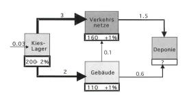
Abb. 3 Der Kieshaushalt des urbanen Systems Schweiz in den 90er-Jahren des 20. Jahrhunderts (Flüsse in Tonnen pro Kopf und Jahr, Lager in Tonnen pro Kopf).
