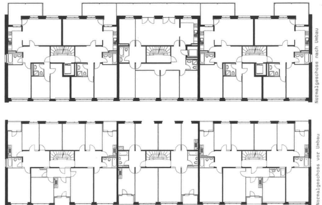
Vischer AG Architekten und Planer, Mehrfamilienhaus Roggenburgstrasse vor und nach der Sanierung, Grundriss OG, Basel, 2002
