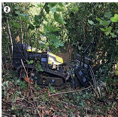
Foto 2-3: la fresa cingolata telecomandata (portata in loco con l'elicottero), qui impegnata con gli aceri
