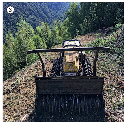
Foto 2-3: la fresa cingolata telecomandata (portata in loco con l'elicottero), qui impegnata con gli aceri
