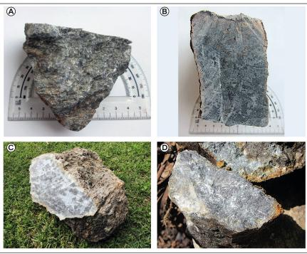
Fig. 5a - Campioni di roccia: A) Borgnone (talco-magnesite-clorite-antofillite); B) Verdasio-Verguno (olivina-orto-pirroseno-tremolite-clorite); C) Moneto (olivina-antofillite-talco-clorite); D) Arcegno-Ciossa (olivina-antofillite-clorite-talco)
