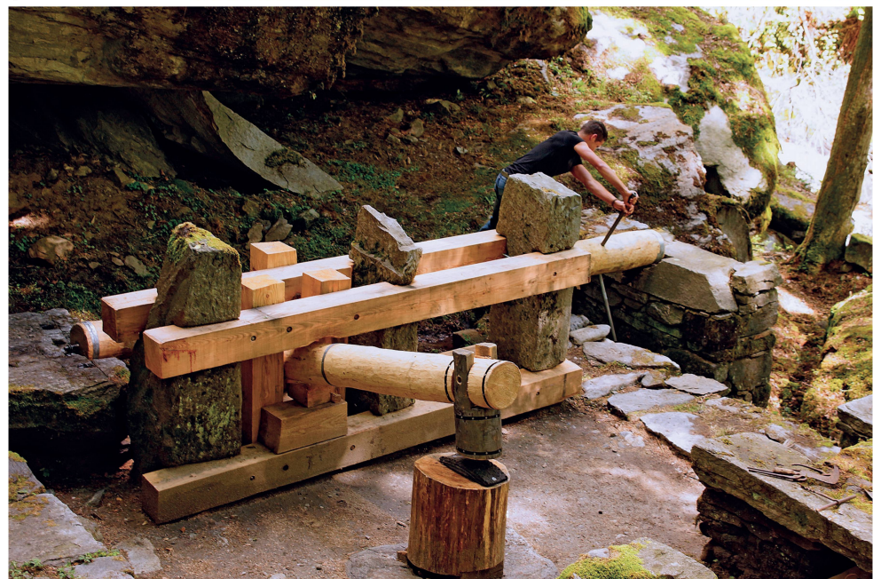
Il maglio ad acqua parzialmente ricostruito a scopo dimostrativo ↓
