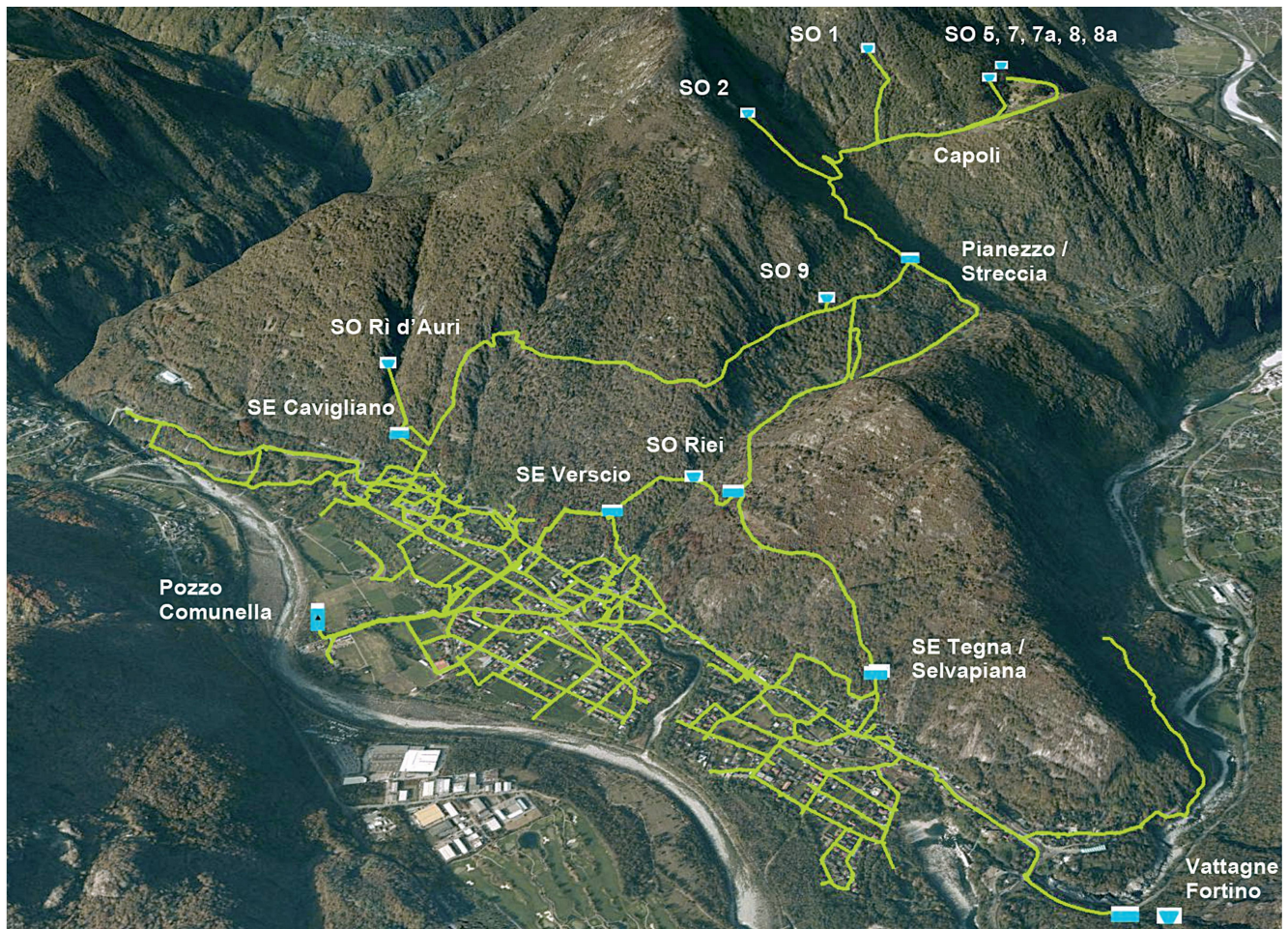
L'acquedotto di Terre di Pedemonte (SO = sorgente, SE = serbatoio)
