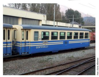
4 vagoni, di cui A 120 (prima classe) e B 121-123 (seconda classe) utilizzati con elettrotreni ABDe 6/6 FART e ABe 8/8 SSIF;
