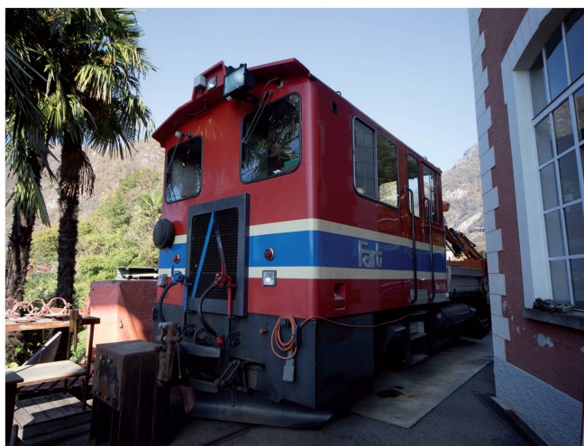
Trattore diesel per la manutenzione della linea, tipo Tm 2/2 n.9.
