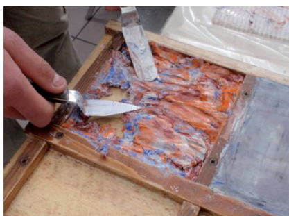
Figura 3 - Impasti policromi per la realizzazione di un "finto marmo".
