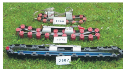
Si noti l'evoluzione del cingolato: il principio è rimasto lo stesso, sono aumentate le dimensioni ed è diminuito l'attrito grazie alla migliore qualità dei materiali.
