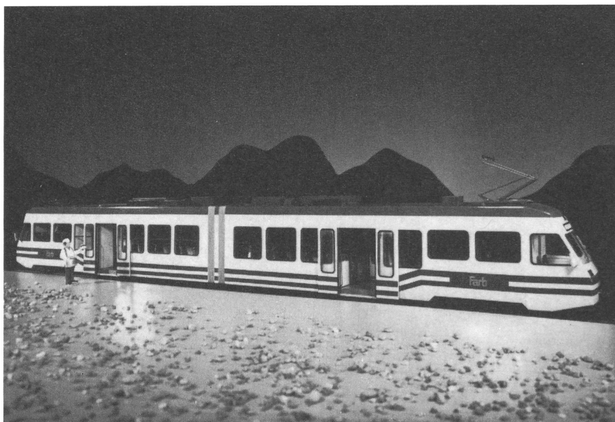
Modello FART - Grande novità nelle costruzioni ferroviarie. I futuri treni a scartamento metrico delle Centovalli, sviluppati da VeVeY e ABB avranno un pianale ribassato che faciliterà l'accesso alle vetture.
