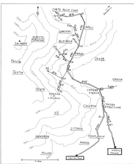
Fig. 1 Schema planimetrico dell'acquedotto consortile 1965-70.
