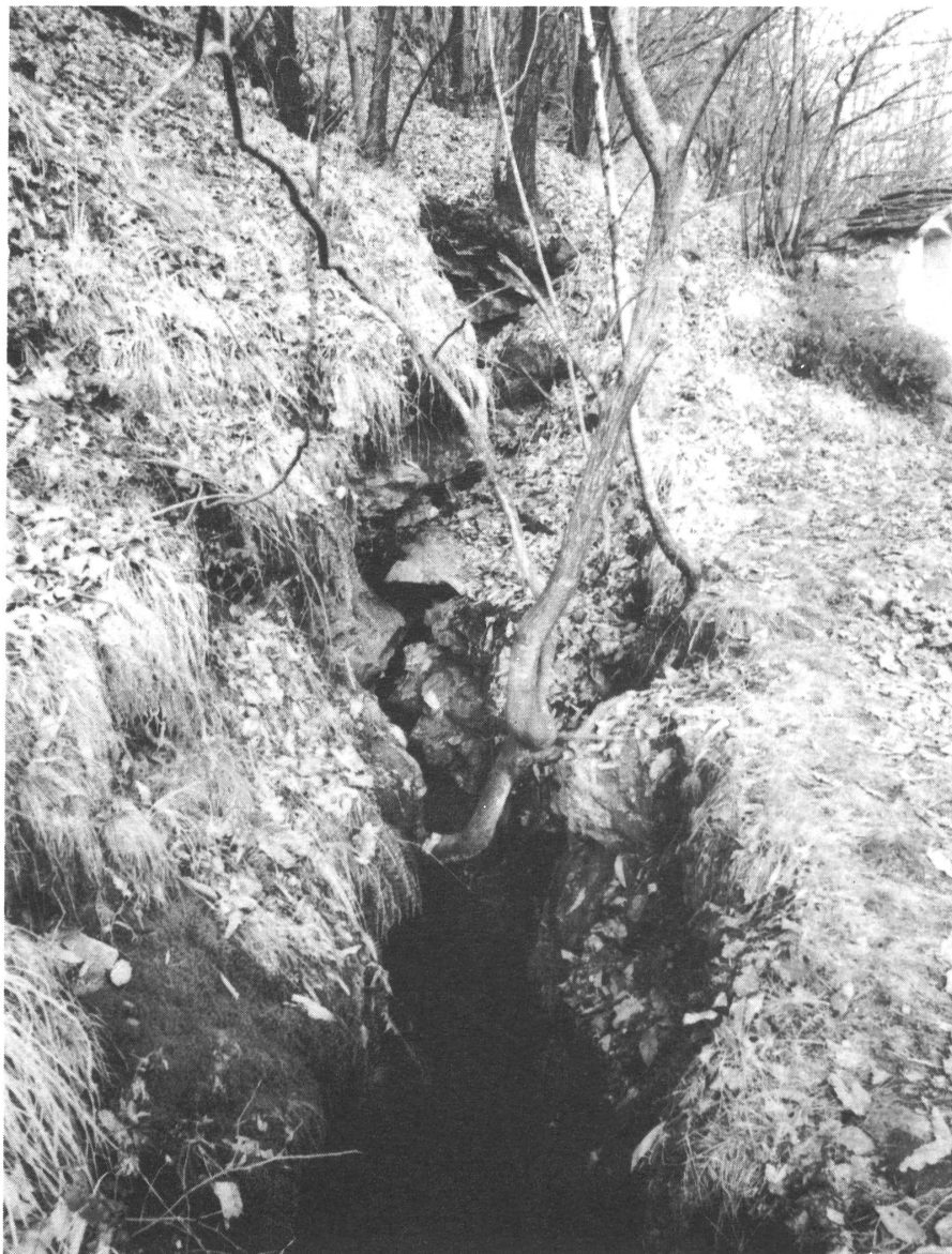
Crepaccio con fissurometro (apparecchio facente parte del sistema di allarme in caso di spostamento della frana).
