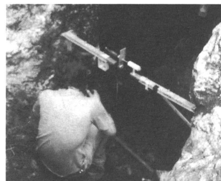
Crepaccio con fissurometro (apparecchio facente parte del sistema di allarme in caso di spostamento della frana).
