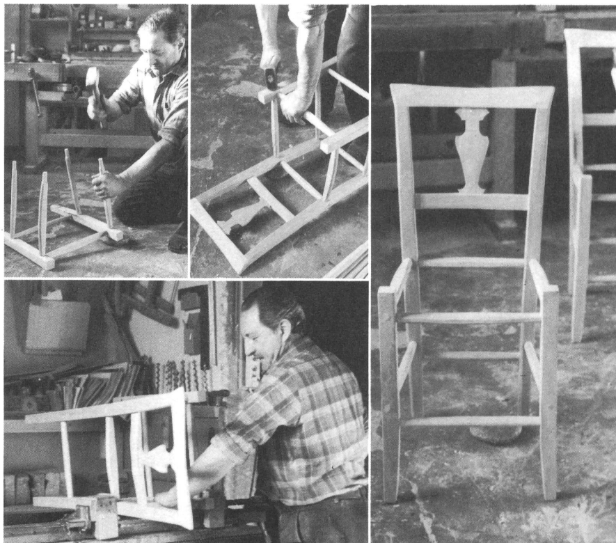
La sequenza delle operazioni necessarie alla costruzione della tipica sedia ticinese.
