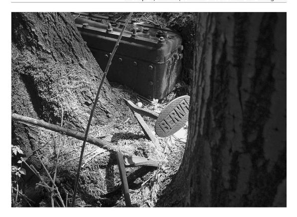
Im Bild ist ein Kupplungs- oder Bremspedal von Berna zu sehen. Wahrscheinlich stammen dieses Pedal und der hinten zu erkennende Motorblock aus einem Lastwagen.
