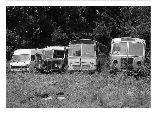
Interessant sind die beiden in der Mitte stehenden Fahrzeuge. Links ist ein 6-Zylinder-Diesel-FBW zu sehen, der vermutlich den Jahrgang 1948 hat. Dabei handelt es sich um einen 20-Plätzer-Bus, das heisst um einen sogenannten Alpenwagen mit einem Faltverdeck in der Länge des gesamten Sitzteiles. Der FBW wurde vorwiegend auf Postautolinien eingesetzt. Bei der Karosserie handelt es sich möglicherweise um eine von Ramseier & Jenzer oder um eine von Hess, Bellach.
