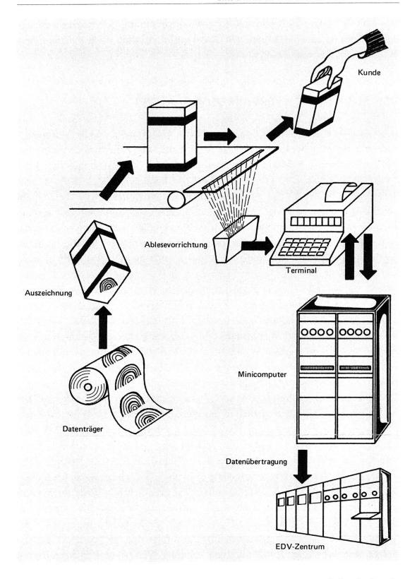
«Die automatisch arbeitende Ableseeinrichtung (scanner) tastet in Sekundenbruchteilen das Codezeichnen ab, wertet dessen Informationen automatisch aus und leitet die Daten an einen Rechner weiter.» (GMZ, APOSS-System Orientierung April 1973, 12)
