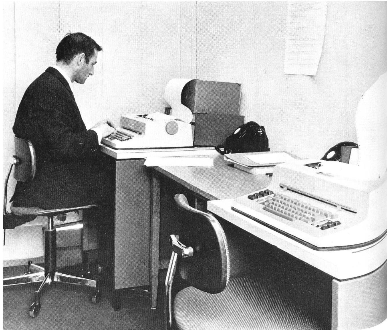
Computerunterstützter Unterricht: Bevor Schüler selbst am Computer-Terminal (hier im Bild) arbeiten können, müssen über diesen dem Computer entsprechende Unterrichtsprogramme eingegeben werden.
