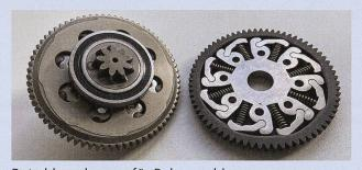
Rutschkupplungen für Bohrmaschinen.
