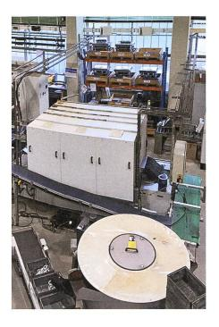
Bei Sicherheitsteilen für die Automobilindustrie werden Kontrollautomaten für die 100-Prozent-Prüfung gefordert.
