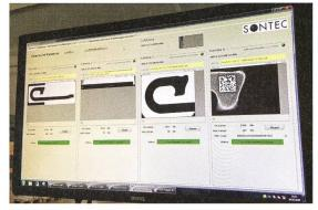
Bei der neusten Generation werden die Teile für die vollständige Rückverfolgbarkeit mit einem DMC-Code beschriftet.
