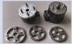
Teile für Stellmotoren für Abgasregelung.
