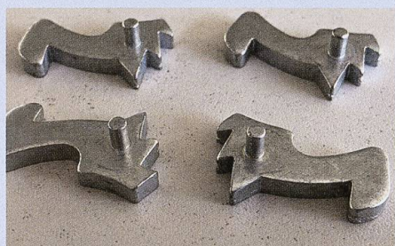
Zahnscheiben (Dicke 4 mm, Pinhöhe 5.3 mm).
