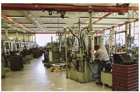
Schiess-Pressen mit 300 kN (30 t) Schnittkraft.
