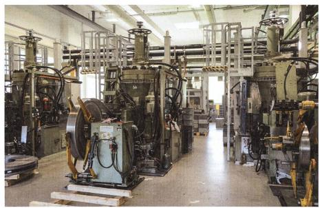
Stanzerei: Schiess-Pressen mit 3000 kN (300 t) Schnittkraft.
