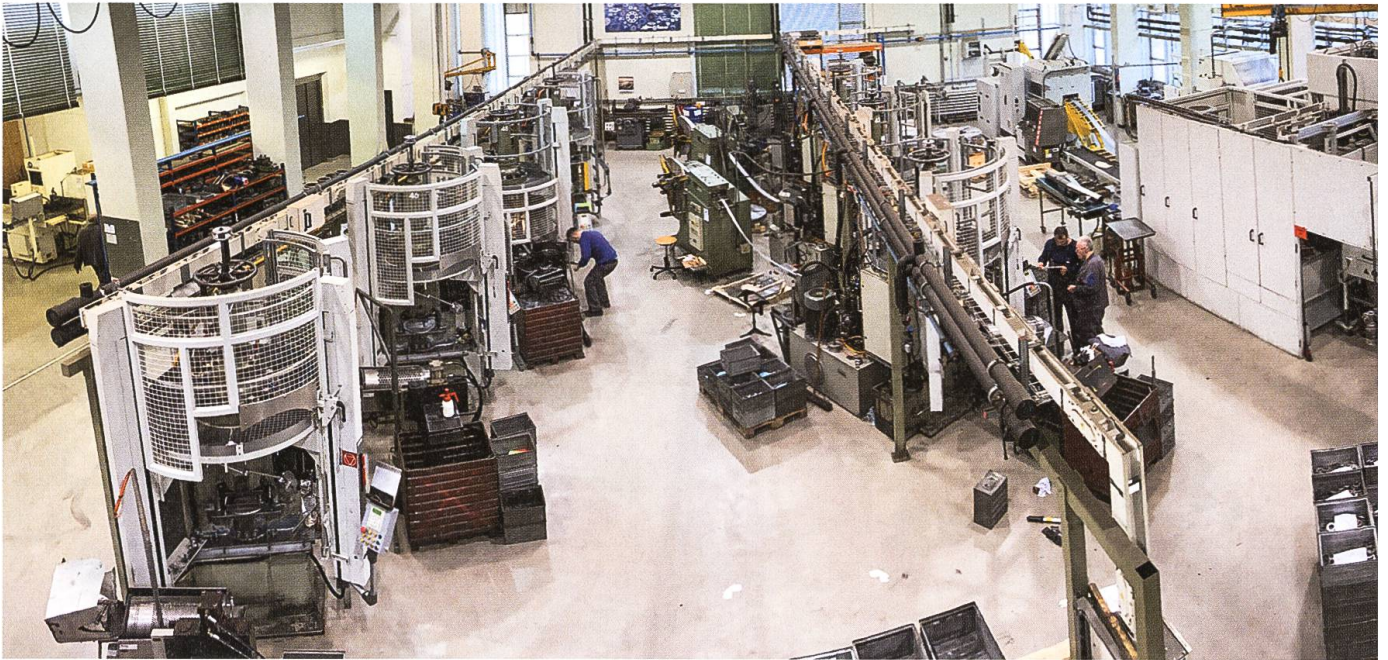
Schliess-Pressen 1000 kN (100 t), nach SUVA-Vorschrift gesichert, rechts die Feintool-Presse X TRA 450 (installiert 2017).
