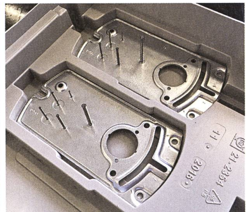
Automat zum Setzen der Achsen in die feingestanzten Basisplatten für Stellmotoren.
