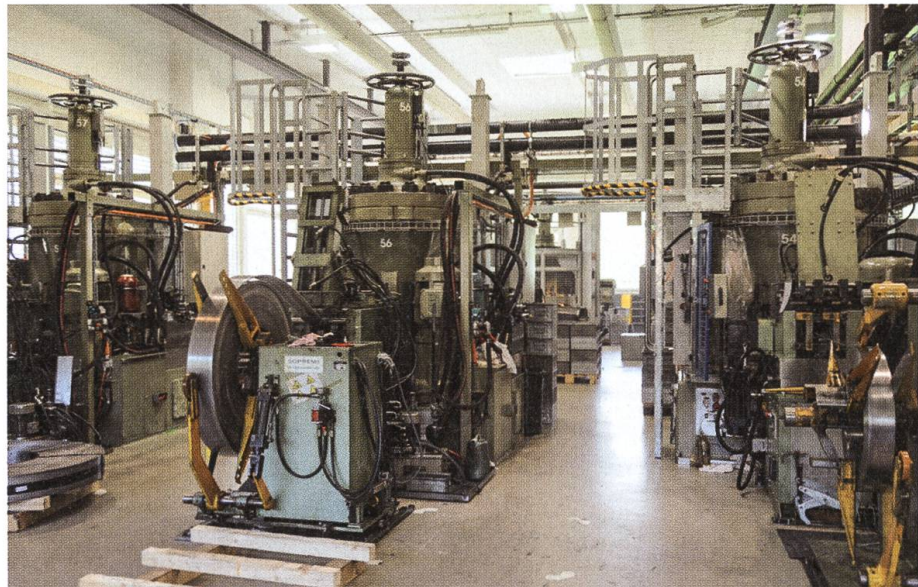
Stanzerei: Schiess-Pressen mit 3000 kN (300 t) Schnittkraft.
