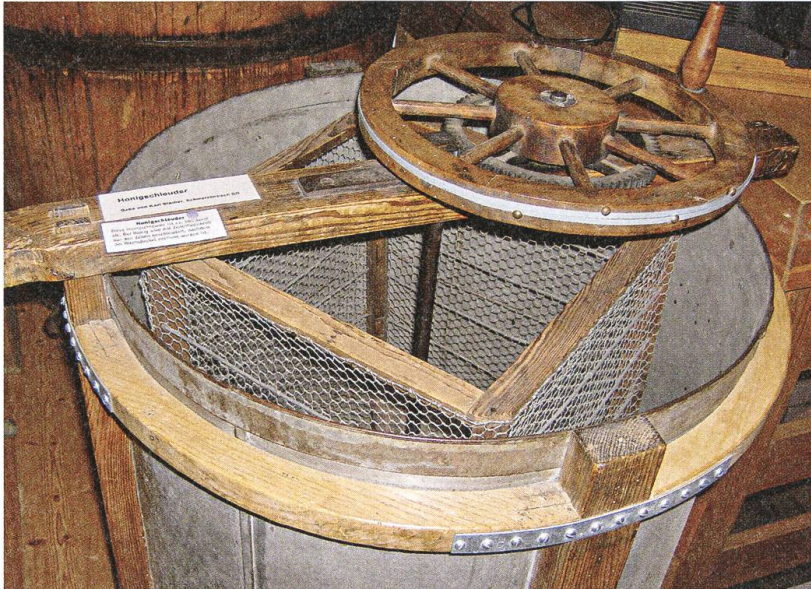
Im 19. Jahrhundert wurde die Honigschleuder erfunden. Dank ihr konnte der Imker Honig gewinnen, ohne die Waben zu zerstören. Die abgebildete Honigschleuder ist zirka 100 Jahre alt. Foto: Linus Kempter.
