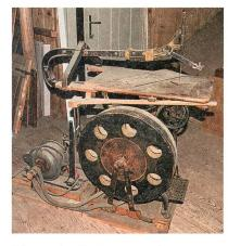
Die zur Laubsäge umgebaute Nähmaschine des Meisters.
