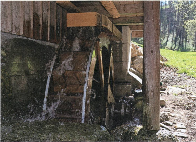
Das überschlächtige Wasserrad der Beistampfi.
