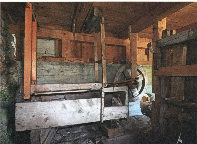
Der Siebapparat scheidet gröbere Knochensplitter aus und liefert so feines Knochenmehl. Fotos: René Güttinger, Nesslau.
