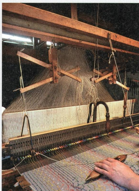
Die Plattstichplatte mit den vielen kleinen Fadenspulen Hinten sind die Litzen zum lochkartengesteuerten Anheben der Kettfäden gespannt. Vorne sichtbar ist die Rückseite der Stoffbahn mit den Stickereien.
