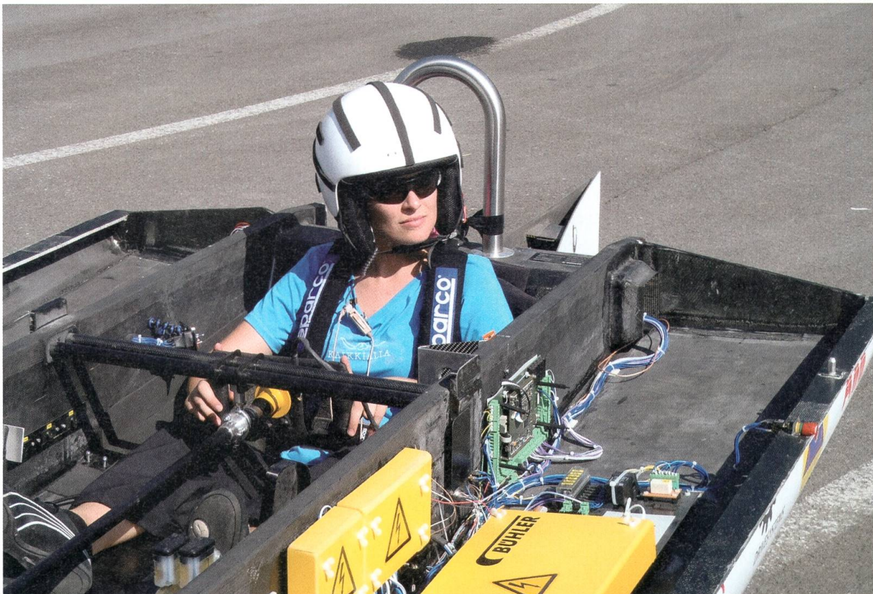
Ein spartanisch ausgestattetes Cockpit, Elektronik-Baugruppen und anderes mehr verbergen sich hinter der stromlinienförmigen Solarverschalung. Foto: SER.
